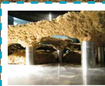
Des expérimentations *in situ* et en laboratoires ont permis d'étudier les mécanismes des inclusions rigides. Pour un sol mou qui aurait tassé de 10 centimètres sans renforcement, on considère en moyenne que les inclusions rigides permettent de réduire le tassement à 1 centimètre.
