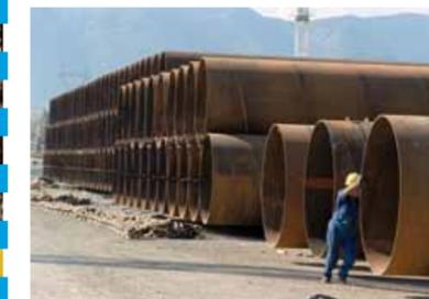
Les tubes en acier permettent de renforcer le fond marin.
